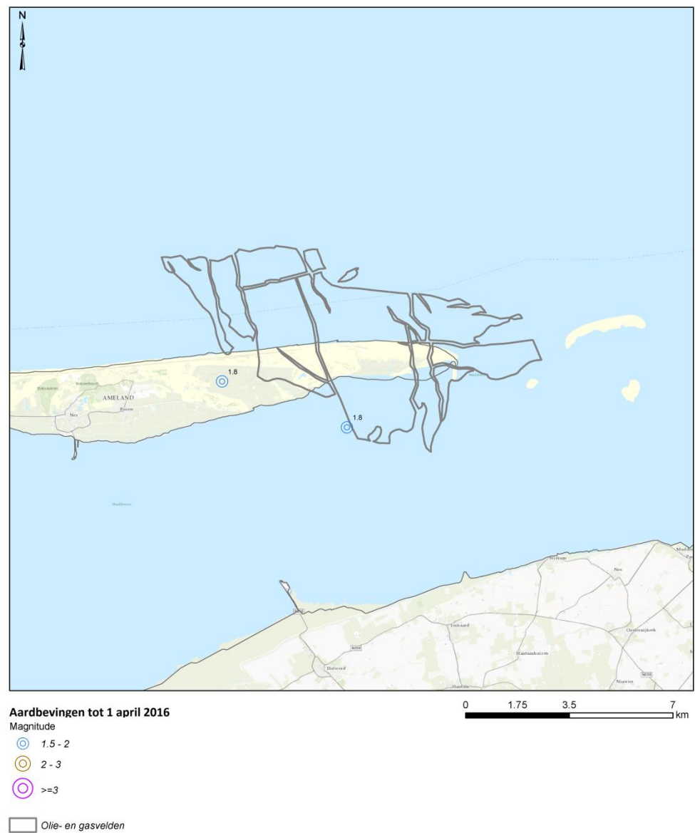
Figuur F.5 Geïnduceerde seismiciteit ( M_L \geq 1,5 ) voor het Ameland-Oost gasveld.
